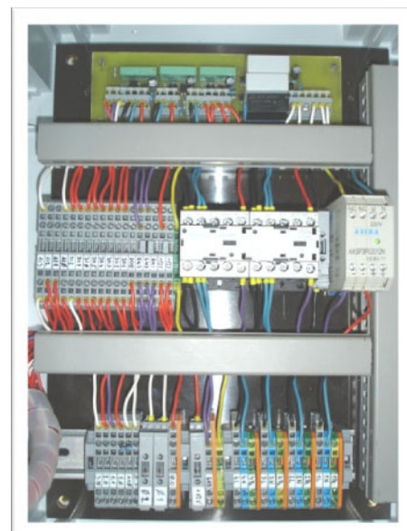
Vnitřní pohled do krabice a připojení ŘS na víko krabice
