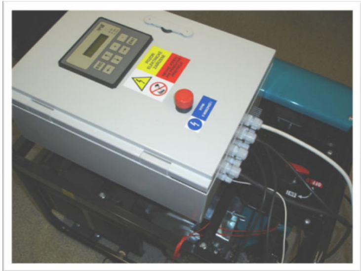
Připojení ŘS k agregátu
